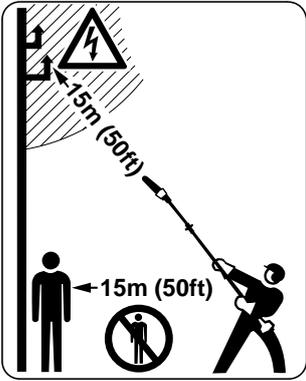
**(D)** Mindestens 15 m (50 ft) Abstand zu stromführenden Leitungen einhalten, um die Gefahr eines elektrischen Schlages zu vermindern. Bei Hochspannung kann ein Stromüberschlag auch über eine größere Luftstrecke erfolgen. Bei Arbeiten im näheren Umfeld von stromführenden Leitungen Strom abschalten.
